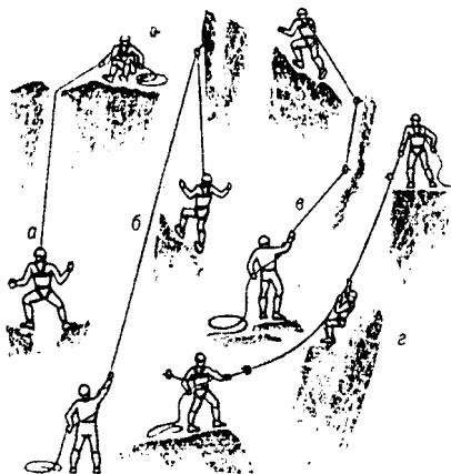
Рис. 4. Способы организации страховки: а – верхняя страховка сверху; б – верхняя страховка снизу; в – нижняя страховка; г – парильная двусторонняя страховка.
